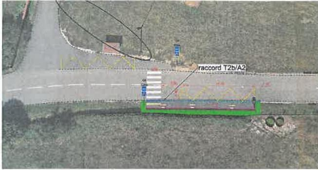
Prochainement, Pays de Montbéliard Agglomération dans le cadre des transports scolaires, aménagera un nouvel arrêt bus sécurisé à hauteur du stade. Cet équipement servira pour les élèves du primaire et du collège. Les travaux consisteront en la construction d'un quai pour le chargement et la dépose des élèves, d'un passage piétons éclairé et de deux zébras à la peinture permettant le stationnement des bus.
